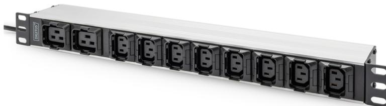
**PDU en aluminium 1U, montage en rack, 8 x C13, 2 x C19 16 A, 230 VCA, 50/60 Hz, fiche IEC C20**
