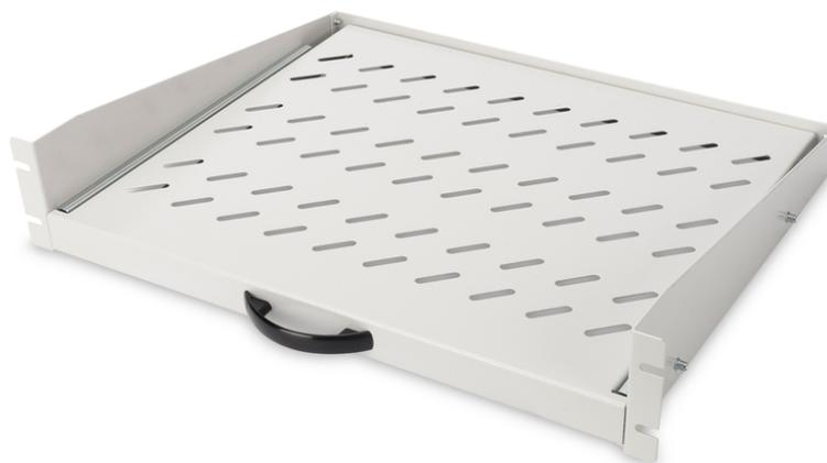
**2U télescop. Tablette pour armoires de 450 mm de profondeur 88 x 483 x 352 mm, jusqu'à 30 kg, gris (RAL 7035)**
