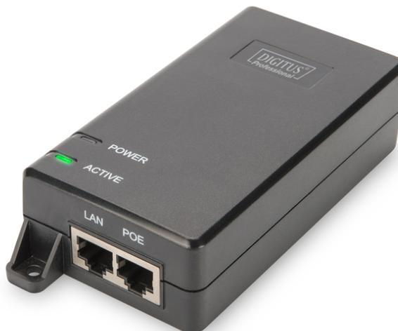
**Iniettore Gigabit Ethernet PoE+, 802.3at Spine di alimentazione: 4/5 (+), 7/8 (-), 30W**
