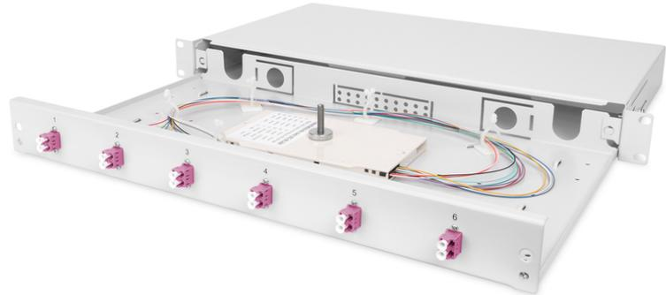
**LWL Spleißbox, 1HE, bestückt, 6x LC DX, OM4 inkl. Spleißkass., gefärbte Pigtaills, Kupplungen**
