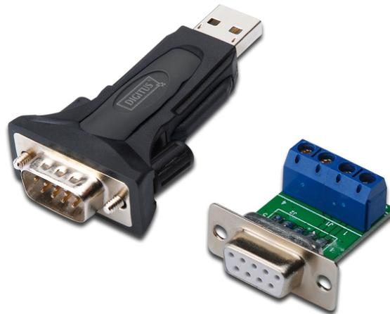
**USB 2.0 zu serieller Konverter, RS485 inkl. USB A Kabel 80cm USB A M / USB A F**
