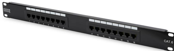
**Pannello patch CAT 6, Classe E, non schermato, 16 porte RJ45, 8P8C, LSA, 1U, montaggio a rack, nero, 482x44x109**
