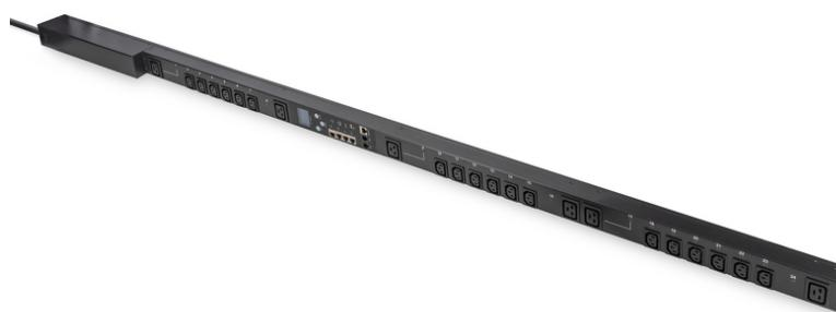
**Çıkış izlemeli ve anahtarlamalı PDU, dikey 18 x C13 ve 6 x C19, 3m, IEC60309 16A fiş**
