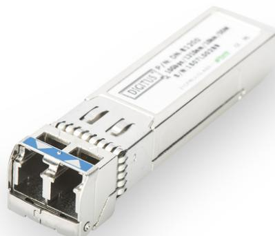
**Modulo SFP+ 10G, multimodale, DDM, compatibile HP Connettore duplex LC, 850nm, fino a 300m, HP**
