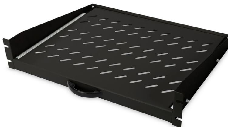
**Estante extraíble de 2UA para armarios con una profundidad a partir de 450 mm 88x483x352 mm, hasta 30 kg, negro (RAL 9005)**
