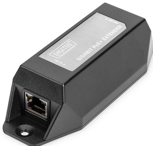
**Gigabit Ethernet PoE+ repeater, 802.3at 1-port, strömstift:3/6(+), 1/2(-), 22W**
