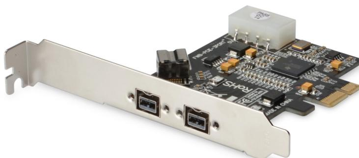
**Scheda di interfaccia IEEE 1394b, PCIexpress, 3 porte, 2x9 pin esterno+1x9 pin interno, XIO2213B**
