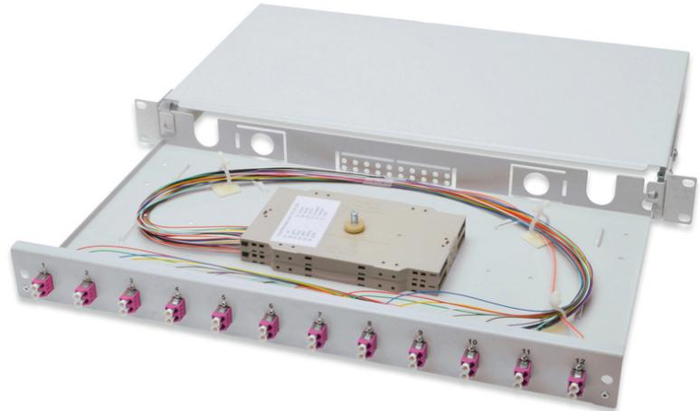
**Boîte d'épissure FO, 1UH, équipée, 12x LC DX, OM4 y compris cassette d'épissure, pigtails colorés, raccords**
