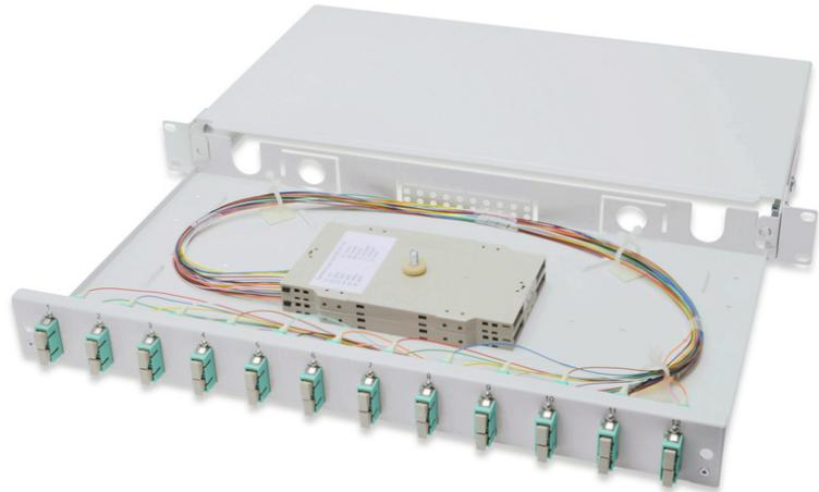
**Scatola di giunzione in fibra ottica, 1U, equipaggiata, 12x SC DX, OM3 incl. cassetta di giunzione, pigtail colorati, raccordi**
